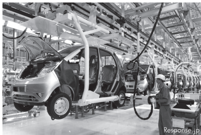
Расми 19. Хатти конвейерии овеза дар сеҳи кузови автомобилҳо
