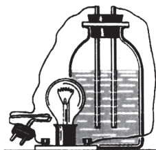
Расми 12. Асбоб барои мушоҳидаи барқгузаронии маҳлулҳо
